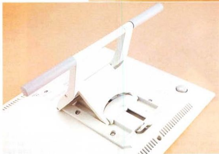
Particolare del sistema di sblocco e di regolazione dell'inclinazione della PL-400, interamente realizzato in alluminio e materiale plastico di alta qualità: si tratta di un ingegnoso sistema a cremagliera, simile a quello usato per i cavalletti degli artisti...
